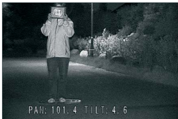
40 m zur Person (IR-LED an, geringe Restbeleuchtung)
