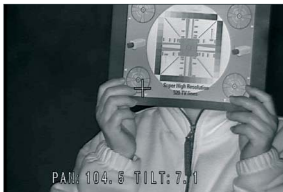
40 m zur Person (gezoomt, IR-LED an, geringe Restbeleuchtung)
